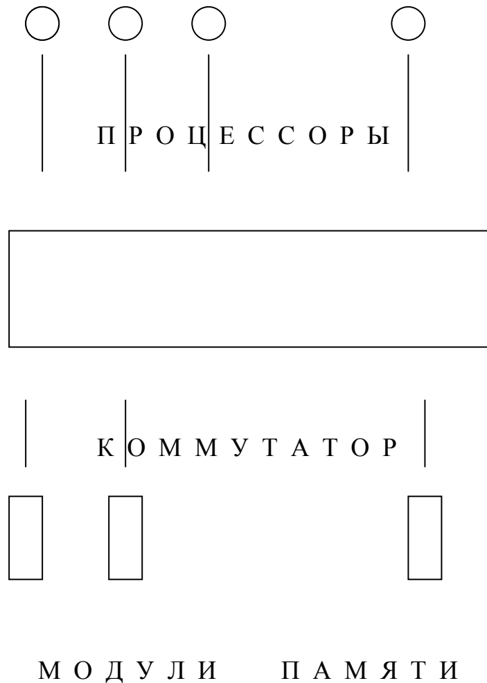
Рис. 1. Схема коммутации процессоров и модулей памяти.
